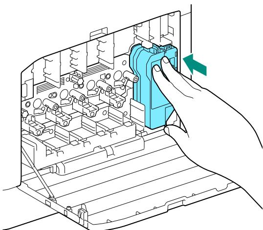
**11.** トナーカートリッジの下部の突起部を本機側のくぼみに合わせ、トナーカートリッジを「カチッ」と音がするまで本機に押し込みます。
