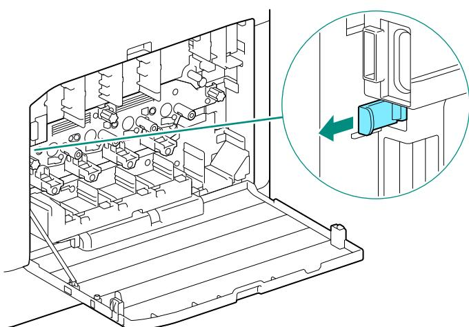
**7.** ドラムカートリッジの穴のいずれかに、清掃棒を止まるまで差し込んでから、引き抜きます。
