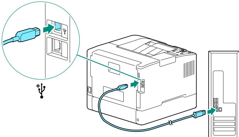
3. USB ケーブルの他方のコネクターを、コンピューターに接続します。
