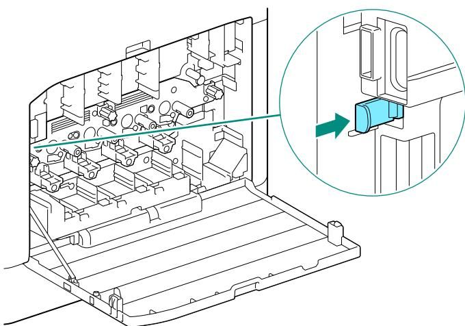
10. トナー回収ボトルを「カチッ」と音がするまで本機に押し込みます。
