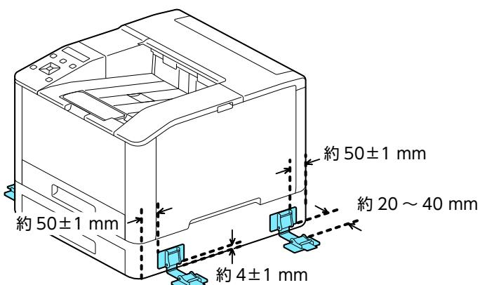
**5. ベルトがたるまないようにして、本機側にもう一方の留め具を貼り付けます。**
