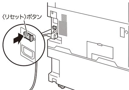
4 ボールペンなどの先のとがったもので、テストボタンを軽く押します。押し込まれていた〈リセット〉ボタンが解除され、突き出ます。これで確認は終了です。
