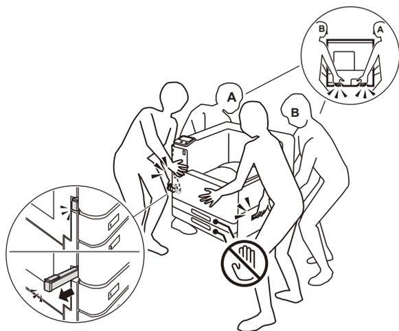
**!** 機械は、付属製品を含めた総質量に耐えられる丈夫で水平な場所に設置してください。機械の転倒などによりケガの原因となるおそれがあります。
