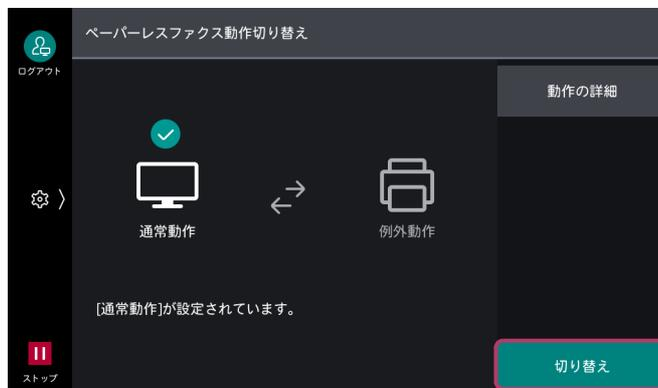
動作切り替え中となり、[例外動作] の上にチェックマークが表示されたら切り替えは完了です。
